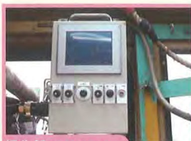
操作盤 (運転席に設置)
